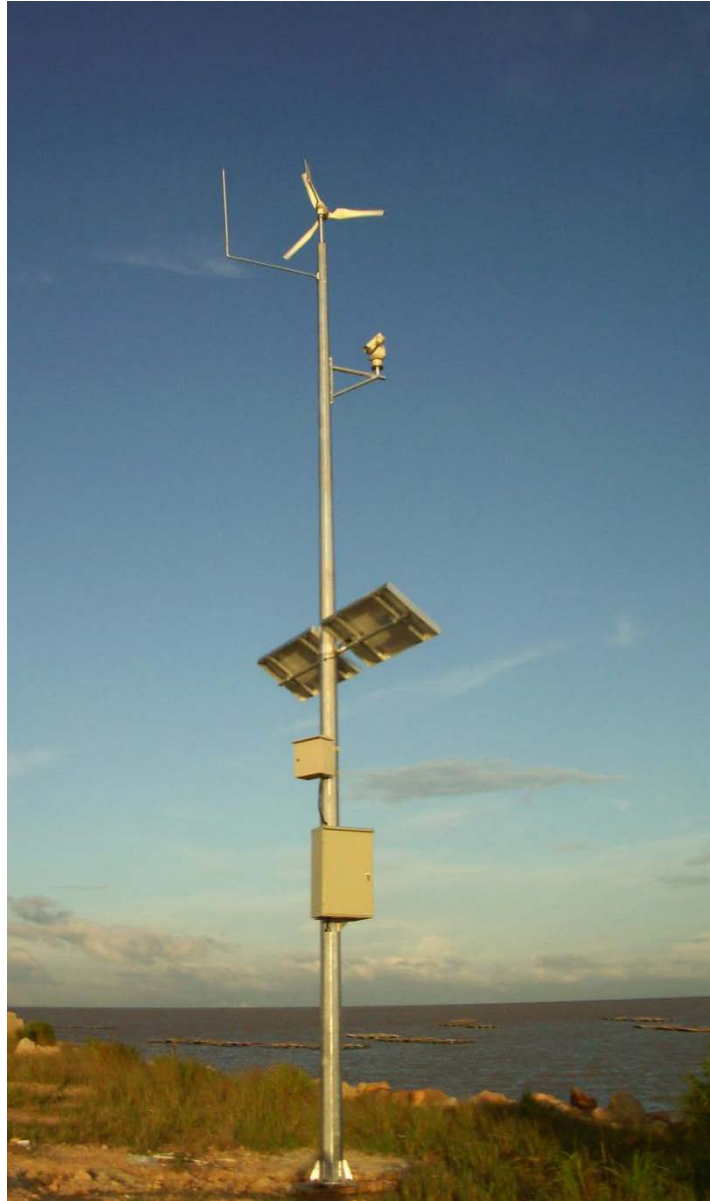
图：风光互补供电系统河道监控应用
